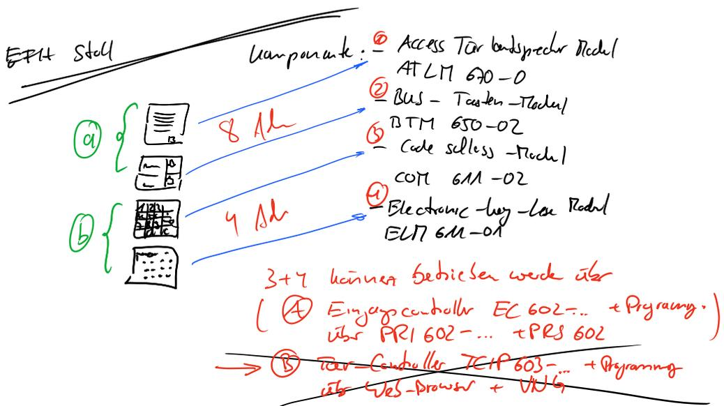
Für die Komponenten ① ist zusätzlich ein „Access Tür landsprecher-Controller mit Netzteil“ ATLC/NG 670-0 benötigt + Server AS 670-01S
